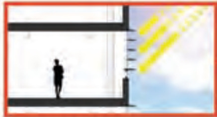
Efficiënte zonwering lamellen aan zuidgevel
